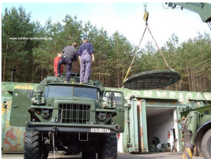
Montage eines Antennenspiegels der R 412A mit Hilfe des ADK 70 auf W50-Basis
